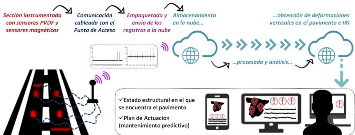
Figura 4. Esquema funcionamiento solución CATIRI.
